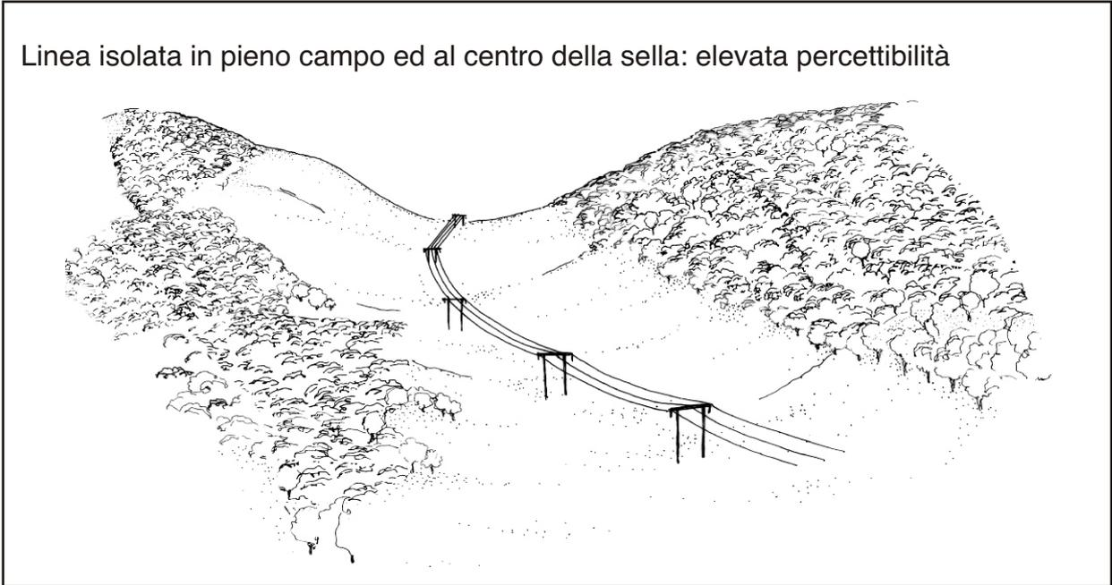
Nel caso di linee elettriche a media tensione che devono attraversare ambiti vallivi o di valico è consigliabile avvicinare il tracciato a corpi boschivi esistenti in modo da spezzare l'isolamento percettivo dell'elettrodotto, favorendone l'assorbimento visivo da parte dei circostanti assetti ambientali.
